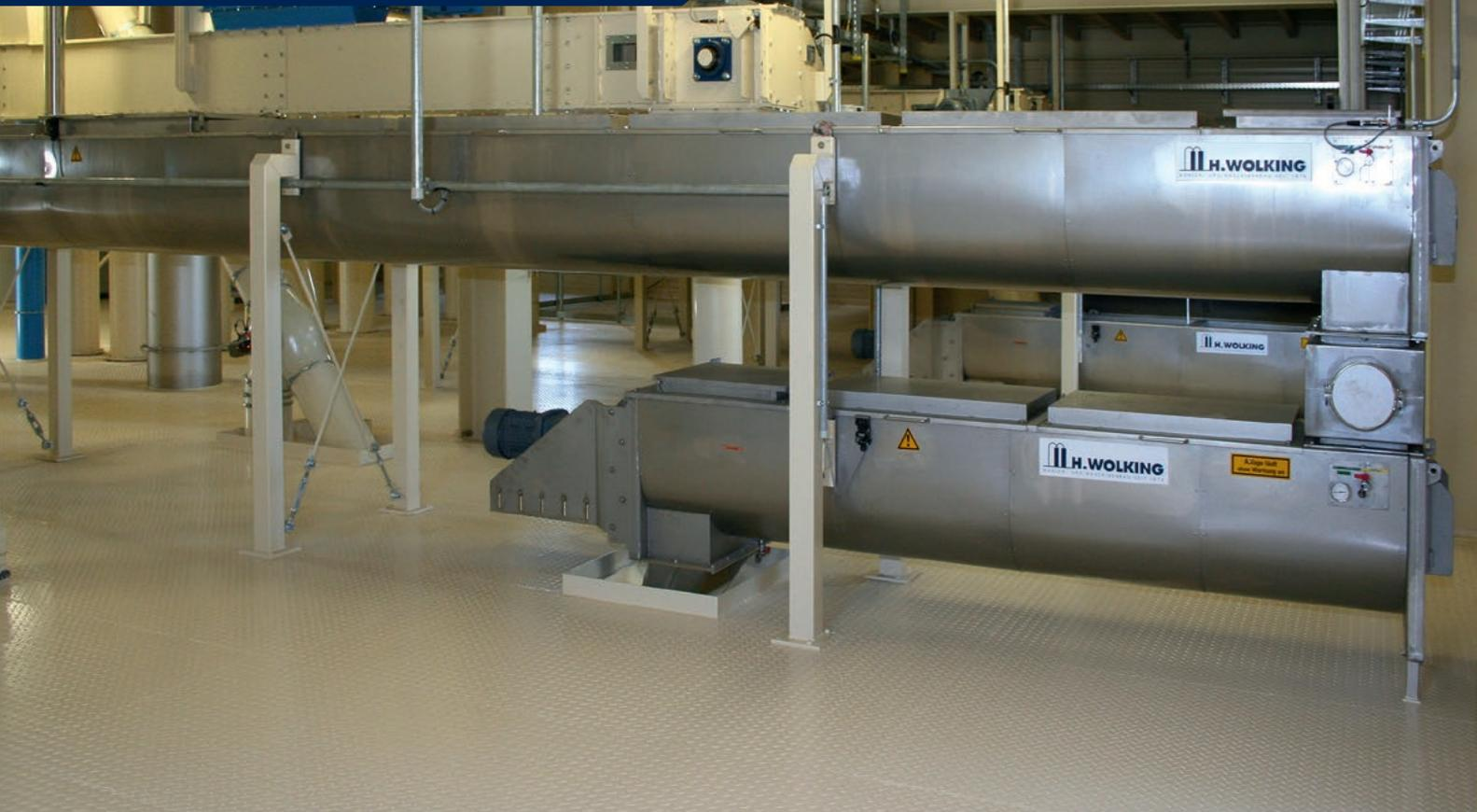
Befettungssystem mit Verweilschnecke – 30 t/h | coating system with idling screw conveyor – 30 t/h
